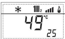
24. Visualización termostato de seguridad con tarjeta ZONA MIX 2 (entrada S1) respectivamente ON y OFF
