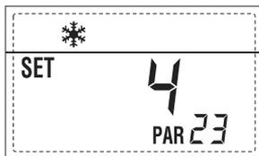
Los parámetros se visualizan con las teclas y , y los valores predeterminado se modifican con las teclas y . La visualización estándar vuelve automáticamente después de 60 segundos, o al pulsar una de las teclas de mando (2 fig.12).
