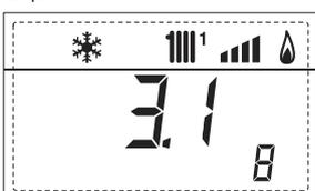
9. Visualización número de revoluciones del ventilador en rpm x 100 (ej. 4.800 y 1850 rpm)
