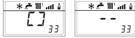
34. Visualización relé solar R2 con tarjeta solar INSOL (respectivamente ON y OFF)
