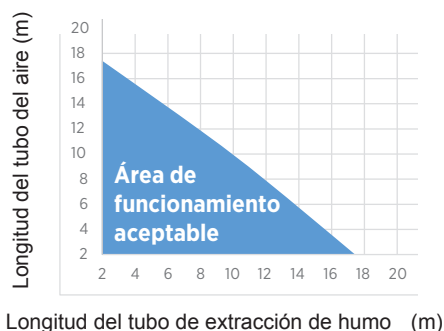
Ilustración 2.21. Diagrama de longitudes de los tubos de aire y de extracción de humos
