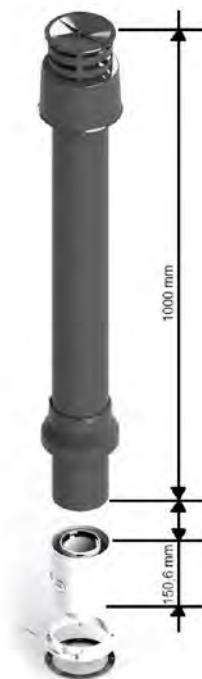
Ilustración 2.15. Conjunto de extracción de humos vertical concéntrico \varnothing 60/100 y dimensiones
