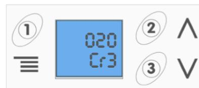
Muestra el valor de la temperatura deseada en el acumulador para la resistencia en alterna conectada en R3. Configurada por defecto a 20°C. Regulable de 10°C a 90°C.
