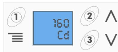
Volumen del acumulador donde se encuentra la resistencia conectada a R1. Configurada por defecto a 160 litros. Regulable de 80 a 500 litros.
