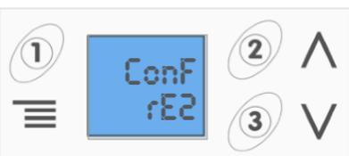
El regulador alimenta R1 hasta alcanzar la temperatura de consigna. Una vez alcanzada, conmuta a la resistencia instalada en R2 hasta alcanzar la temperatura de consigna para R2. Esta configuración establece una prioridad de suministro para R1.
