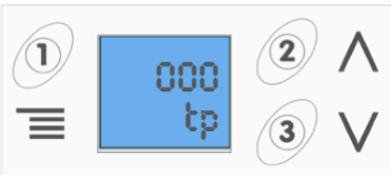
Muestra la tensión máxima instantánea de entrada al regulador en voltios (V) producida por el campo fotovoltaico.
