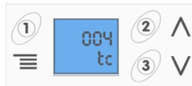
Tiempo definido para el calentamiento del volumen de agua en R1. Si con FV no se alcanza consigna, activa R3 de apoyo. Configurada por defecto a 4 horas. Regulable de 1 a 10 horas.
