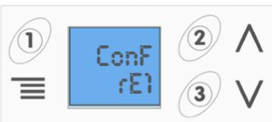
El regulador alimenta R1 hasta alcanzar la temperatura de consigna. Una vez alcanzada, se detiene y queda en reposo hasta que la temperatura baje del valor definido en la consigna.
