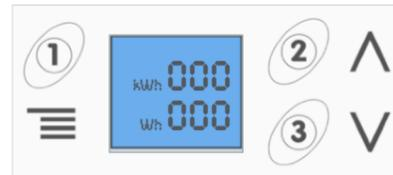
Muestra la energía producida acumulada que se ha transmitido a través de R2. Valor superior en kWh e inferior en Wh.
