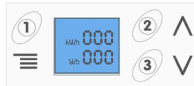
Muestra la energía producida acumulada que se ha transmitido a través de R1. Valor superior en kWh e inferior en Wh.
