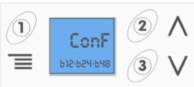
Una vez alcanzada la temperatura de consigna en R1. Una vez alcanzada, conmuta a carga de batería hasta valores de 14,4V (12V), 28,8V (24V), y 57,6V (48V). La prioridad sigue siendo R1. Capacidad mínima 40Ah.
